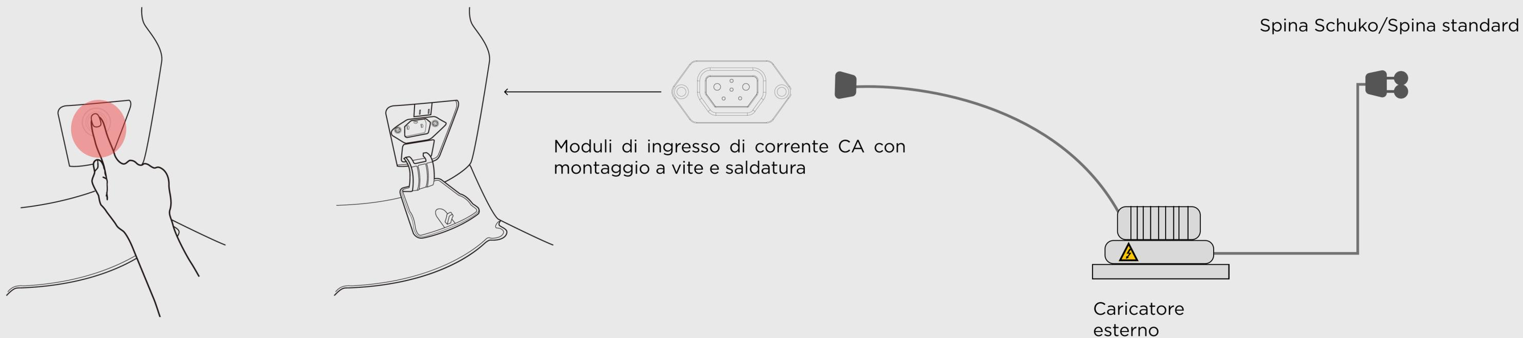
Utilizzare una presa Schuko standard. Premere delicatamente la parte superiore della copertura per accedere alla presa di ricarica. Collegare il caricatore e monitorare l'indicatore luminoso per sapere quando la carica è completa.
